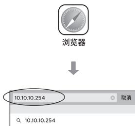
(3) 打开手机浏览器，在网址栏输入10.10.10.254，点击搜索进入系统设置。
