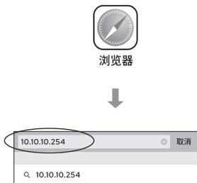
(1) 打开手机浏览器，在网址栏输入10.10.10.254，点击搜索进入系统设置。
