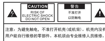
⚠ 三角形内加闪电标志，提醒用户本机内有未经绝缘的“危险电压”存在，可能会发生触电危险。
