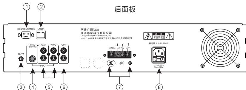
1. 终端配置端口（配合我司串口线使用）
