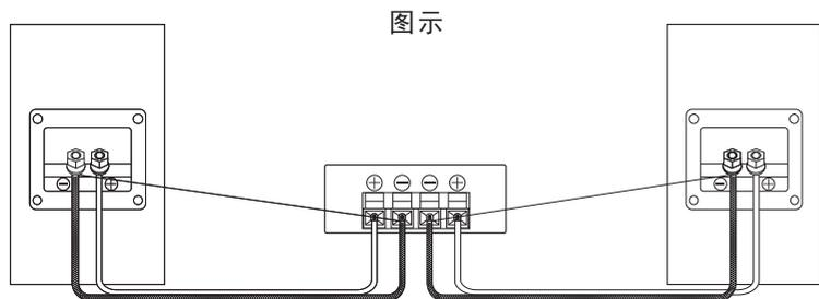
如果左右极性没有正确连接好，那它产生的声感及声音重放效果将会受到极大的影响。
